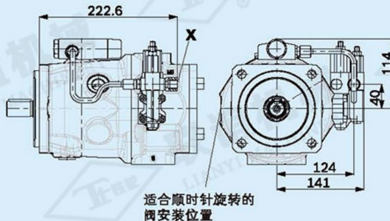
▼ DRG - 远程控制压力控制器
